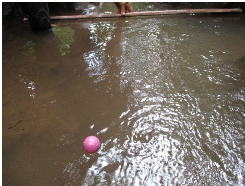
Fig. 2 Aplicación del método de flotador para medición de Caudal
