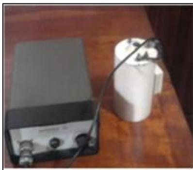
**Imagen 10. Magnetograma de Precisión Protónica**
