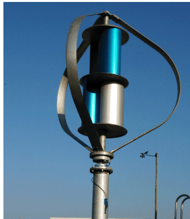
Figura 5. Turbina híbrida que combina el concepto Savonius con el concepto Darrieus.
