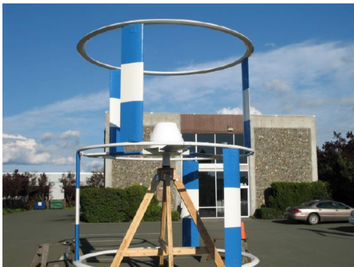
Figura 14. Rotor Darrieus-Masgrowe con dos niveles.
