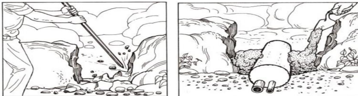
Figura 22. Apertura de orificio y posicionamiento del tubo en el orificio y ajuste.
