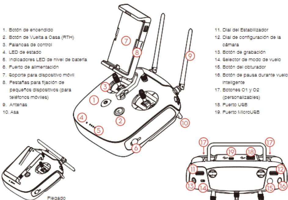
Ilustración 1, Control remoto Phantom 4. Fuente: DJI, 2018
