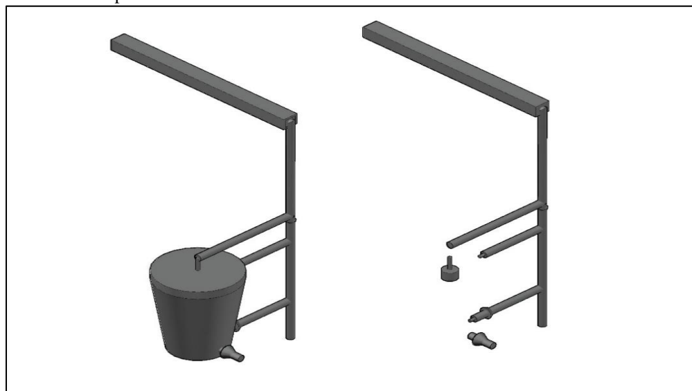
Ilustración 19 Sistema De Aprovechamiento De Agua Lluvia-Vista Con Conexiones
