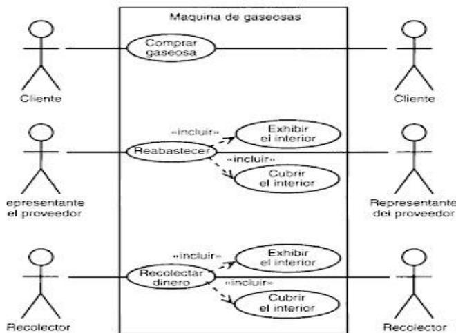
Nota. Diagrama de caso de uso de una máquina de gaseosas. Fuente: (Blogger, 2012)
