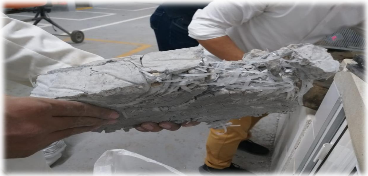
Ladrillo de concreto con agregado PET 50 gramos
