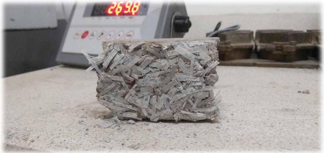
Capa de PET adherida al concreto del ladrillo
