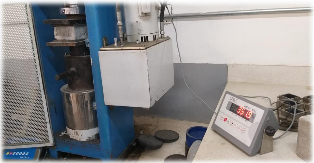
Calibración de la máquina de compresión
