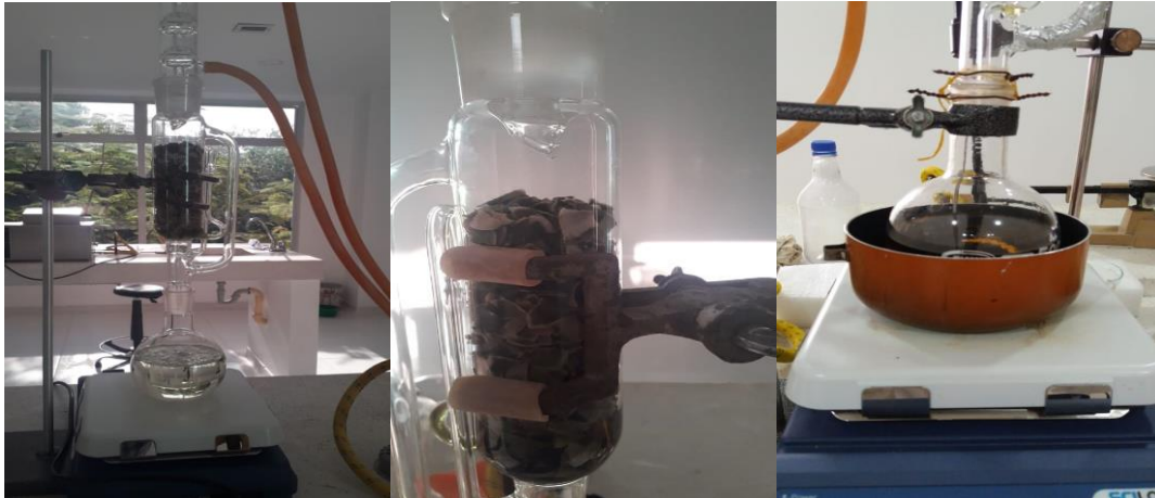
Figura 1: Montaje equipo soxhlet
