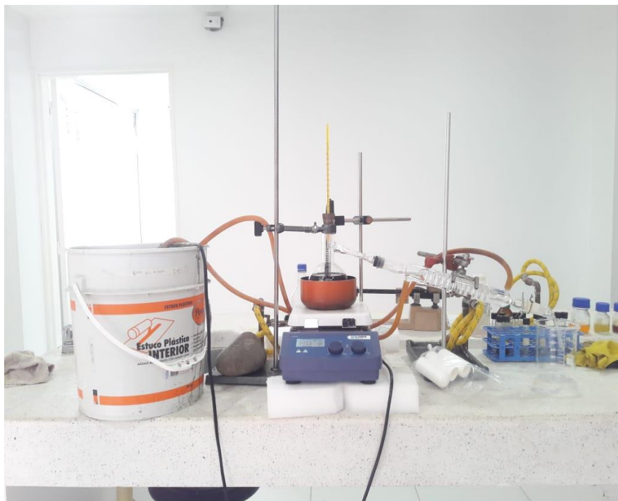
Figura 2:Montaje Destilación Simple
