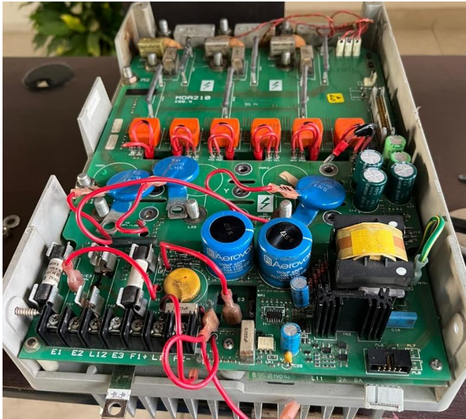
Figura 29. Desensamble del Drive Mentor II.
