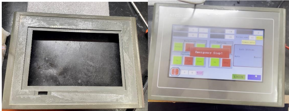
Figura 39. Display al cual se le hizo cambio de touch.
